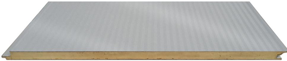
Panel sándwich de fachada de 35mm de espesor con tornillería oculta. El acabado exterior es **microperfilado de diamante en silver** mientras que el interior tiene un perfilado estándar. Este tipo de panel es ideal para utilizar en construcciones de un estilo más bien arquitectónico gracias a su acabado moderno y a que no se ven las fijaciones utilizadas para instalarlo.
