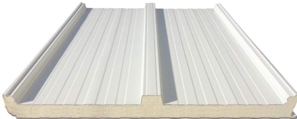
Panel cubierta sándwich de 50mm de espesor, 3 greclas con tornillería oculta. Su diseño con sistema machiembrado y con una colocación de tapajuntas le otorgan el máximo grado de estanqueidad y durabilidad de las juntas.
