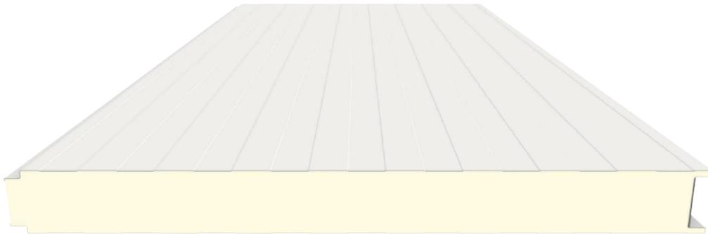
Panel sándwich de fachada frigorífico. Panel de 80mm de espesor con tornillería vista. Este panel están fabricados en línea de producción en continuo y están compuestos por dos láminas de acero, unidas por un núcleo de espuma rígida de poliuretano. Especialmente diseñado para utilizarlo en la industria agroalimentaria (manipulación, conservación, congelación de los alimentos, etc)
