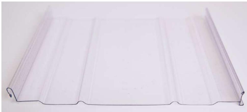
Polycarbonato compacto en color opal con sistema de encastre “engatillado”. Las lamas son de 250mm de ancho por 3000 o 6000 mm de largo, y pueden montarse de manera simple y rápida. El tipo de montaje modular permite completa estanqueidad del producto sin tener que agregar accesorios extra. **Posee protección UV en ambas caras**
