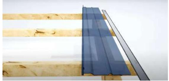
Cortar el extremo de la primer lama para que quede plano y encastrarlo en el perfil ya fijado.
